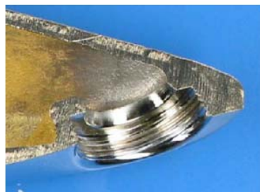
Sezione di un rubinetto nel punto di uscita dell'acqua
